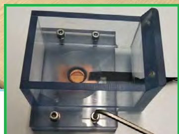
Cuウエハに作用極を装着した、スラリー容器（電解槽）
