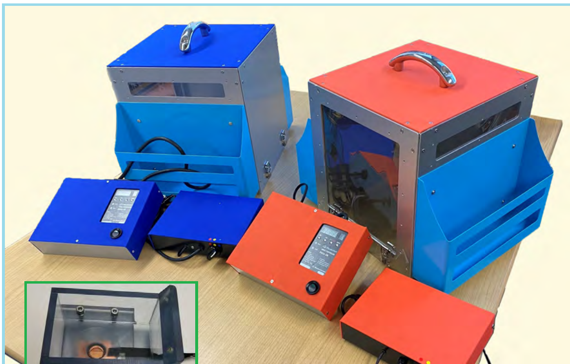
Cuウエハに作用極を装着した、スラリー容器（電解槽）
