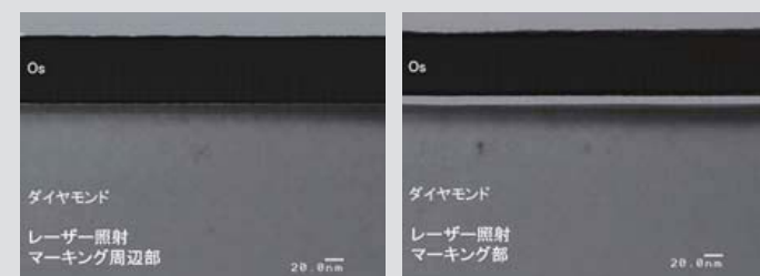
図8 fsレーザー照射ダイヤモンド基板の断面TEM画像
