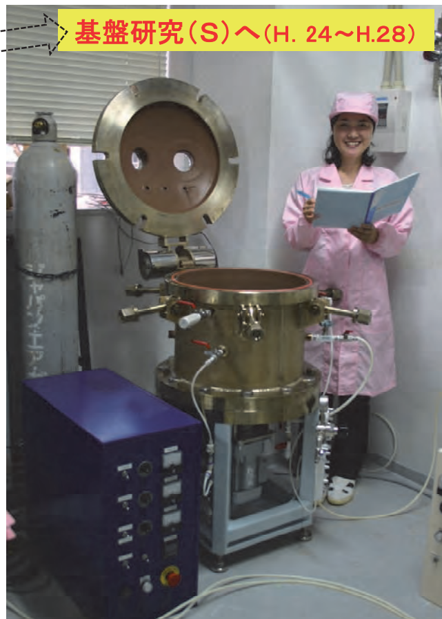
図8 両面同時加工に挑戦した密閉式ベルジャー型CMP装置とその波及効果—超精密加工技術に関する研究実績—
